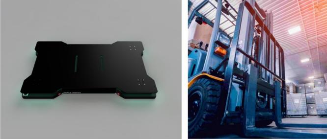
TRUST SMITH株式会社が有するKagheho / YOKOHAMA RUNNERは自己位置推定アルゴリズムと環境地図生成アルゴリズムを活用することで、工場内等において自動で経路設計、さらには継続的な経路修正・障害物検知・自動回避を実現させています。加えて、複数のセンサーを組み合わせたことにより精度が高い荷役制御が可能で、AGV（無人搬送車）だけでなくAGF（無人搬送フォークリフト）の実現も可能です。
