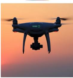
TRUST SMITH株式会社が有するDEEP HORNETはドローンの自動航行・高精度での離着陸を行うアルゴリズムです。予め指定された範囲を自動で航行しながら、画像認識技術と組み合わせることで、指定した物体の監視や異常検知を行います。また、ドローンの課題の一つである駆動時間について、ボールを使った安全で高精度な離着陸の実現により、自動バッテリー交換を実現しています。
