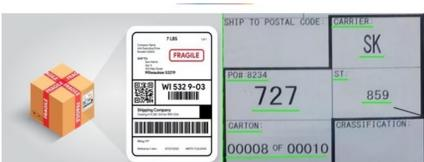
TRUST SMITH株式会社が有するラベル識別AIは画像認識によりラベルの位置特定を実施し、OCR（光学文字認識）によるラベル情報読み取りや、ロードセルによる重量測定をすることで、ラベル識別を自動化しています。
